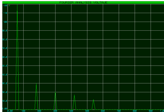
Fig. 61. Espectro de amplitud de armónicos de tensión en la carga con todas las fuentes activas en software de Proteus. Elaboración propia.
