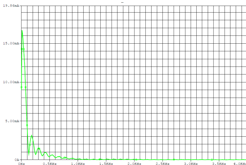
Fig.45 Espectro de amplitudes de armónicos en la carga en el escenario 5. Elaboración propia.
