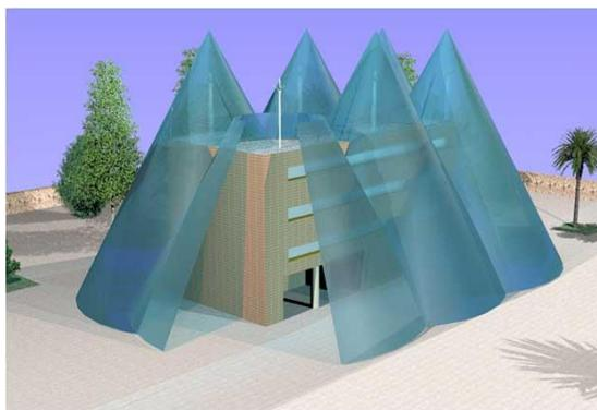
Figura 2 Protección mediante pararrayos Franklin y mallas Faraday (Ingesco, 2013)
