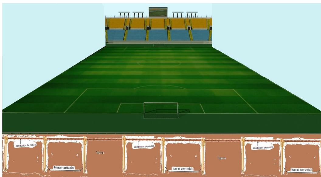
Figura 26 Conexión anillo en tierra interconectada vista frontal de la cancha de fútbol. Fuente: elaboración propia.
