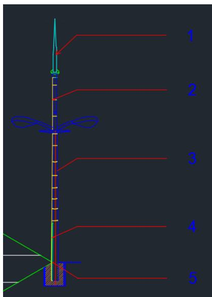
Figura 13. Elementos del modelo de sistema de apantallamiento propuesto. Fuente: elaboración propia
