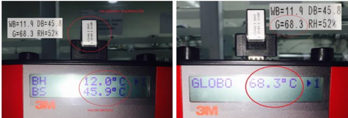
Fotografía 28. Monitor de estrés térmico con verificación de calibración.
