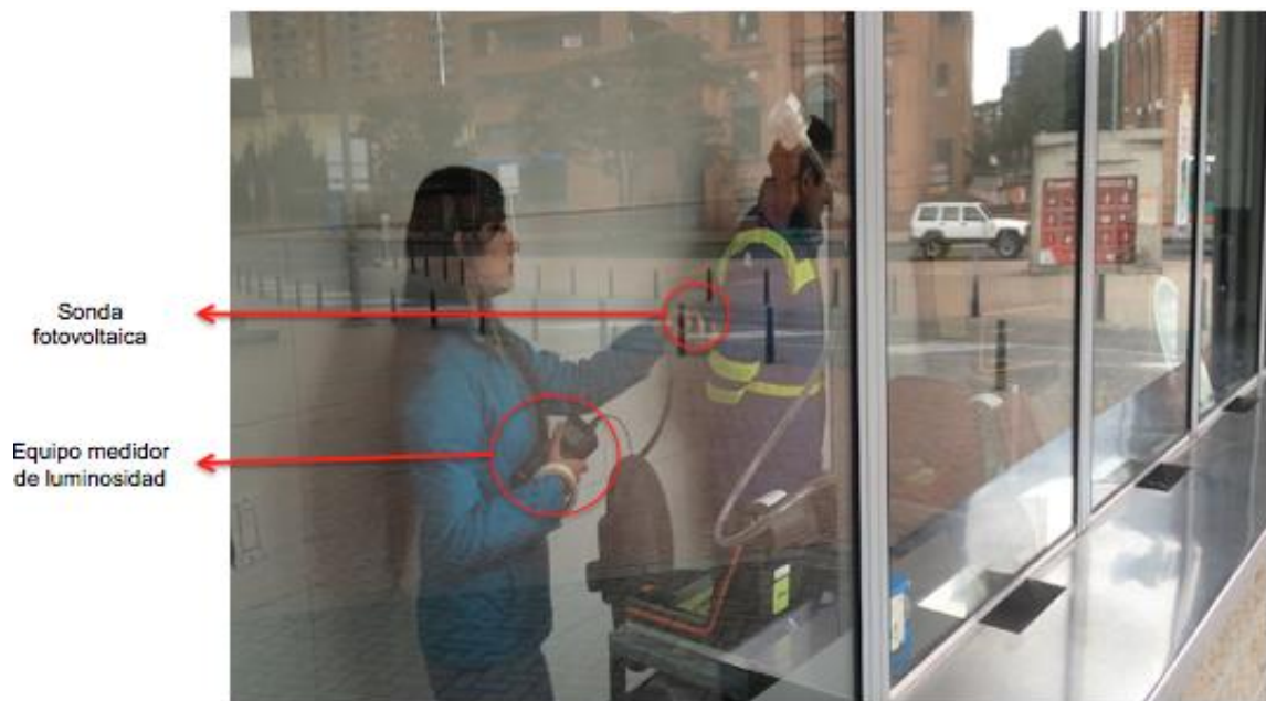
Fotografía 30. Medición de intensidad lumínica en el interior de las taquillas.
