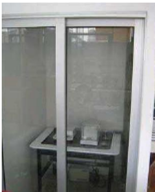
Fotografía 26. Filtros de PM T en desecador y balanza en condiciones ambientales controladas
